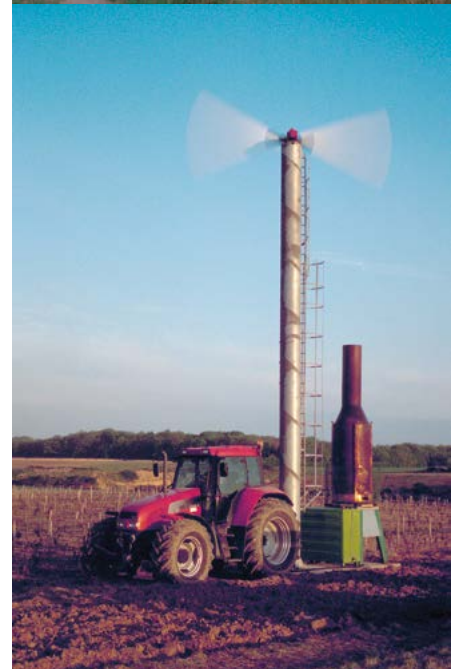
▲ Eoliennes antigel, 10 m de hauteur, lutte contre le gel de 0°C à -2°C par brassage de l'air (© INRAE - Jean-Marie BOSSENNEC)
