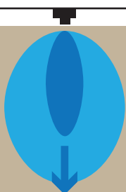
▲ Diffusion de l'eau sous les goutteurs selon la nature du sol © Matthieu Chanel
