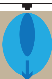
▲ Diffusion de l'eau sous les goutteurs selon la nature du sol © Matthieu Chanel
